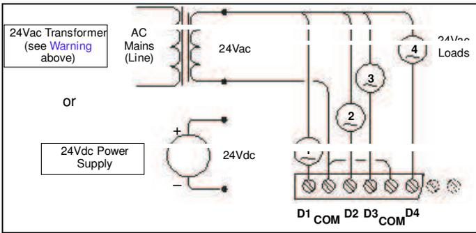
**Fig. 8. Relay output wiring diagram**
