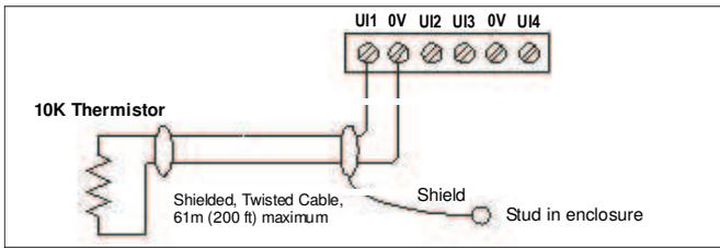
Fig. 4. Thermistor wiring
