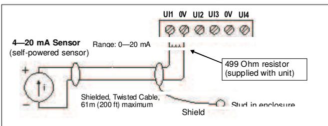
Fig. 6. 4-20 mA wiring
