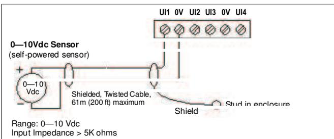
Fig. 5. 0-10 Vdc wiring
