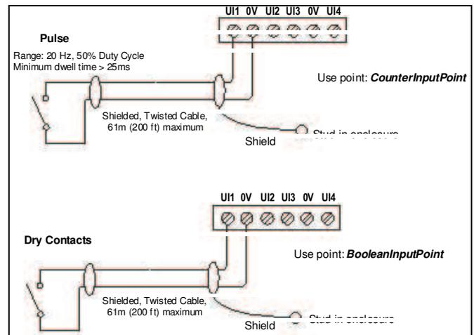
Fig. 7. Binary input wiring
